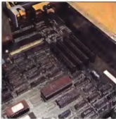
Nel photo-chip si distinguono i quattro chip previsti per l'incremento di capacità e velocità di elaborazione: anche la memoria di lavoro è il processore Intel 80386.
